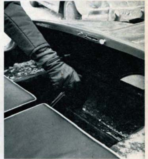
YKSINKERTAISEN ohjaamon kaikki laitteet. Lasikuidun reunassa ovat valokatkaisin, maadotuskatkaisin ja tyyppikiilpi (jos sitä nyt laitteena voidaan pitää). Jalokatilan edessä näkyy kookas ja käytännöllinen "hansikaslokero". Ohjaussauvan asennot: a) vapaalla, b) "nappi laudassa" ja c) täyskäännös oikealle.
