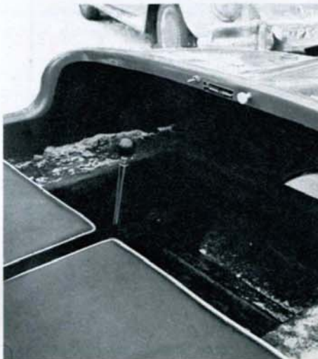
YKSINKERTAISEN ohjaamon kaikki laitteet. Lasikuidun reunassa ovat valokatkaisin, maadotuskatkaisin ja tyyppikiilpi (jos sitä nyt laitteena voidaan pitää). Jalokatilan edessä näkyy kookas ja käytännöllinen "hansikaslokero". Ohjaussauvan asennot: a) vapaalla, b) "nappi laudassa" ja c) täyskäännös oikealle.
