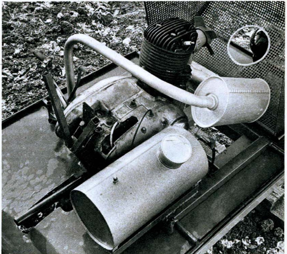
KUVA 17. Moottori, pakoputkisto ja polttoainesäiliö sijoitettuina yläkehikkoon. Huomas huollon helppous.
