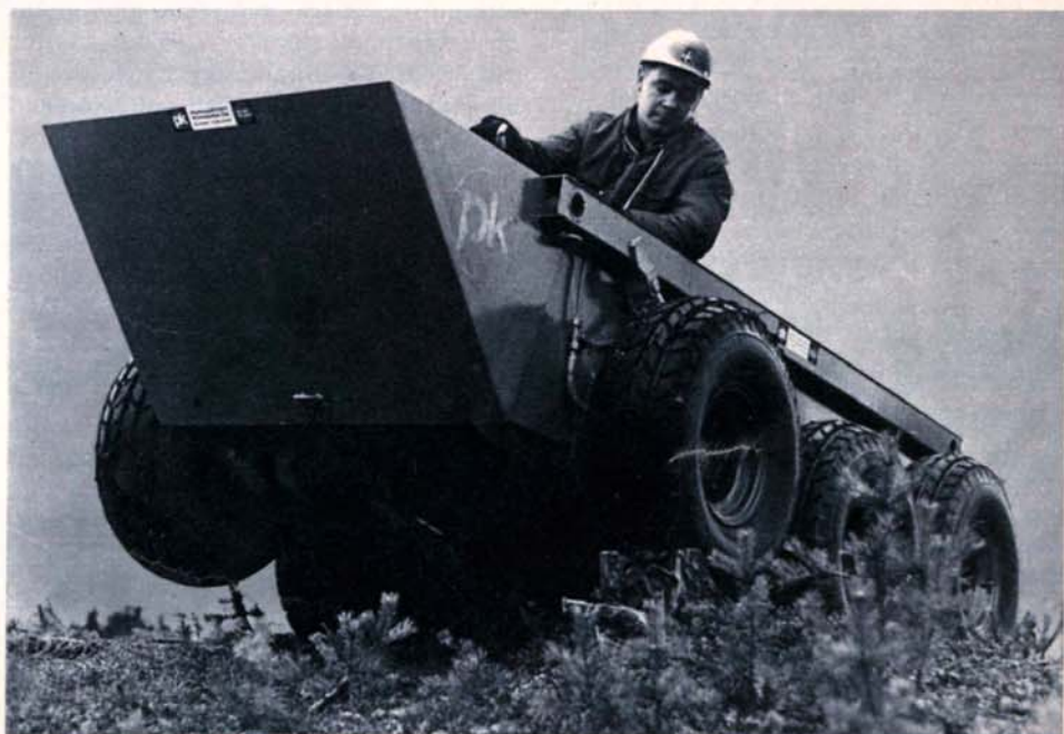
SUOMESSA suunniteltu ja rakennettu kokeilujoneuvo, jonka avulla selvitettiin näppärän veto- ja ohjausjärjestelmän soveltuvuus maastokäyttöön. Aivan ilmetty mönkiäinen, tosin amerikkalaisia veljiään hieman isompi.
