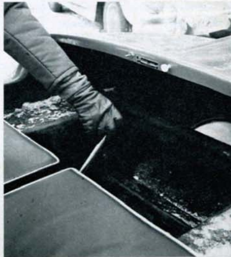
YKSINKERTAISEN ohjaamon kaikki laitteet. Lasikuidun reunassa ovat valokatkaisin, maadotuskatkaisin ja tyyppikiilpi (jos sitä nyt laitteena voidaan pitää). Jalokatilan edessä näkyy kookas ja käytännöllinen "hansikaslokero". Ohjaussauvan asennot: a) vapaalla, b) "nappi laudassa" ja c) täyskäännös oikealle.
