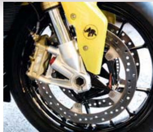
BREMBON valmistama etujarru yhdistettynä Boschin elektroniikkaan takaa luokan lyhyemmän jarrutusmatkan.
