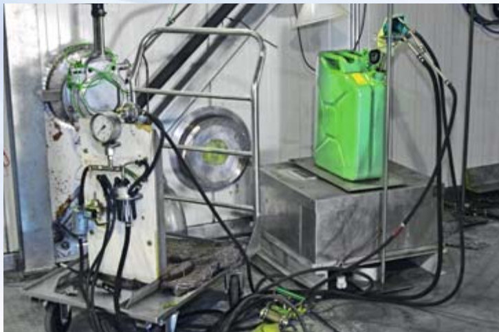
↑ POLTTOAINE syötettiin auton polttoainejärjestelmään tarkkuusvaa'an kautta, jolloin tiheyden perusteella pystyttiin mittaamaan todellinen litramääräinen kulutus kokeen aikana.
